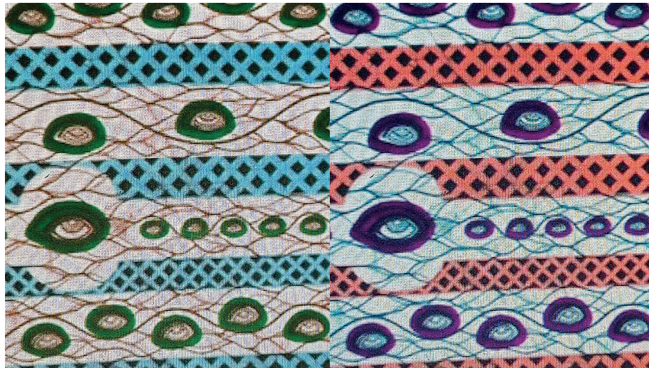
Figura 7: Ejemplo de material termocrómico cuando está frío (izquierda) y cuando está más caliente (derecha)
